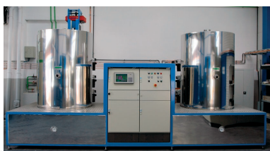
Instalación tandem de nitruración por plasma.
