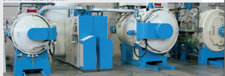
PLANTA DE TRATAMIENTO TERMICO EN VACIO UHARTE ARAQUIL, NAVARRA
