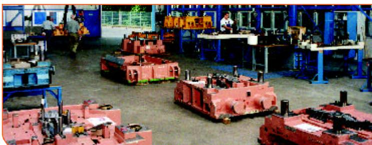
Instalaciones de Dörrenberg Edelstahl GmbH para la recepción de utillajes destinados a ser recubiertos por método PVD ó CVD. El servicio 'full service' incluye desmontaje, montaje y ajuste dimensional en nuestras instalaciones.
